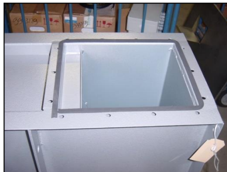
Figure 7 – Application de la bande d'étanchéité
