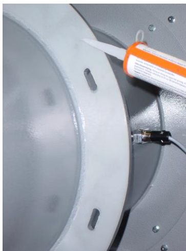
Figure 2 – Plaque de montage du brûleur avec trous oblongs
