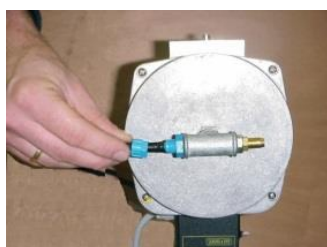
Рисунок 11. Подсоединение датчика давления воздуха
