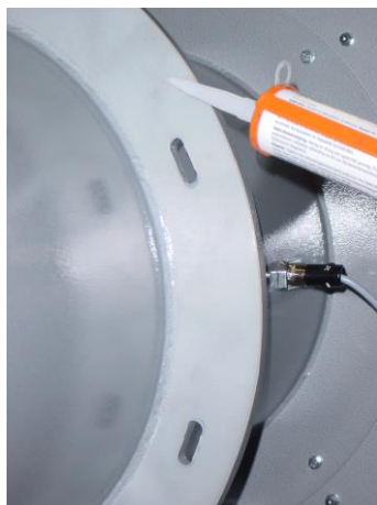
Рисунок 2. Монтажная пластина горелки с регулировочными отверстиями
