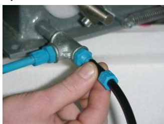
Рисунок 11. Подсоединение датчика давления воздуха
