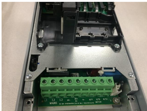
Рисунок 22. Подсоединение частотно-регулируемого привода
