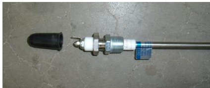
Рисунок 25. Электрод сигнализации о низком уровне воды
