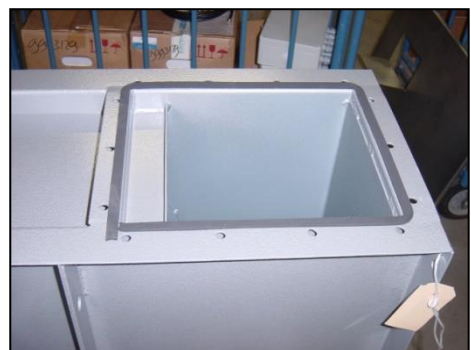
Figura 7 Colocación de la cinta selladora
