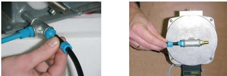
Figura 11 Conectar el sensor de presión de aire
