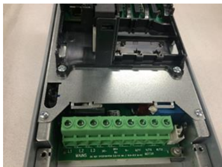
Figura 22 Conexiones de la transmisión de frecuencia
