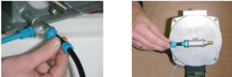
Figura 11 Conectar el sensor de presión de aire
