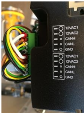
Figura 20 Conexiones del servomotor
