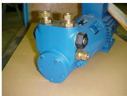
Figura 15 Bomba de aceite para quemadores TR/RKB
