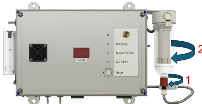
Figure 21a – Filtre à échantillon
