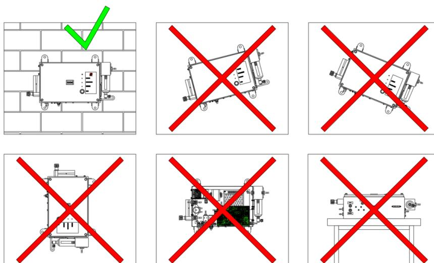
Figure 2 – Installations correcte et incorrecte
