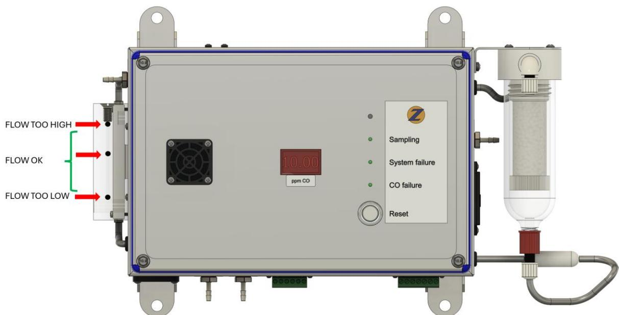
Figure 20 – Débitmètre avec vanne à pointeau
