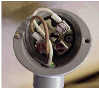
Figure 23 – Thermomètre PT1000
