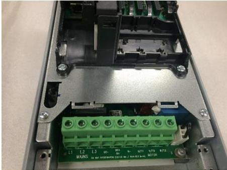
Figure 22 – Raccordement du variateur de fréquence
