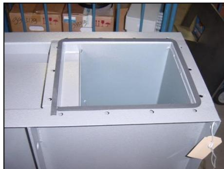
Figure 7 – Application de la bande d'étanchéité
