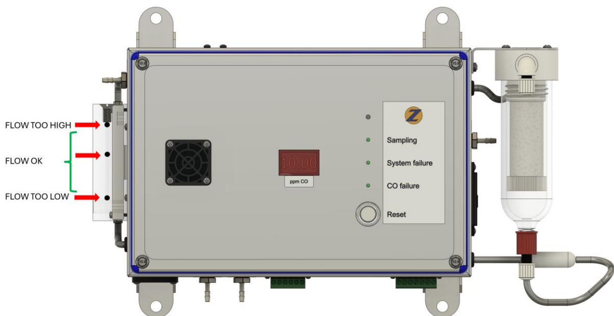
figuur 20, flowmeter met naaldventiel
